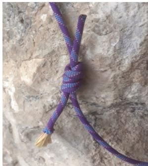
**Bild 1: Kevlarschlinge, es ist der gelblich braune Kern sichtbar. Der zu empfehlende Knoten ist der doppelte Spierenstich.**
